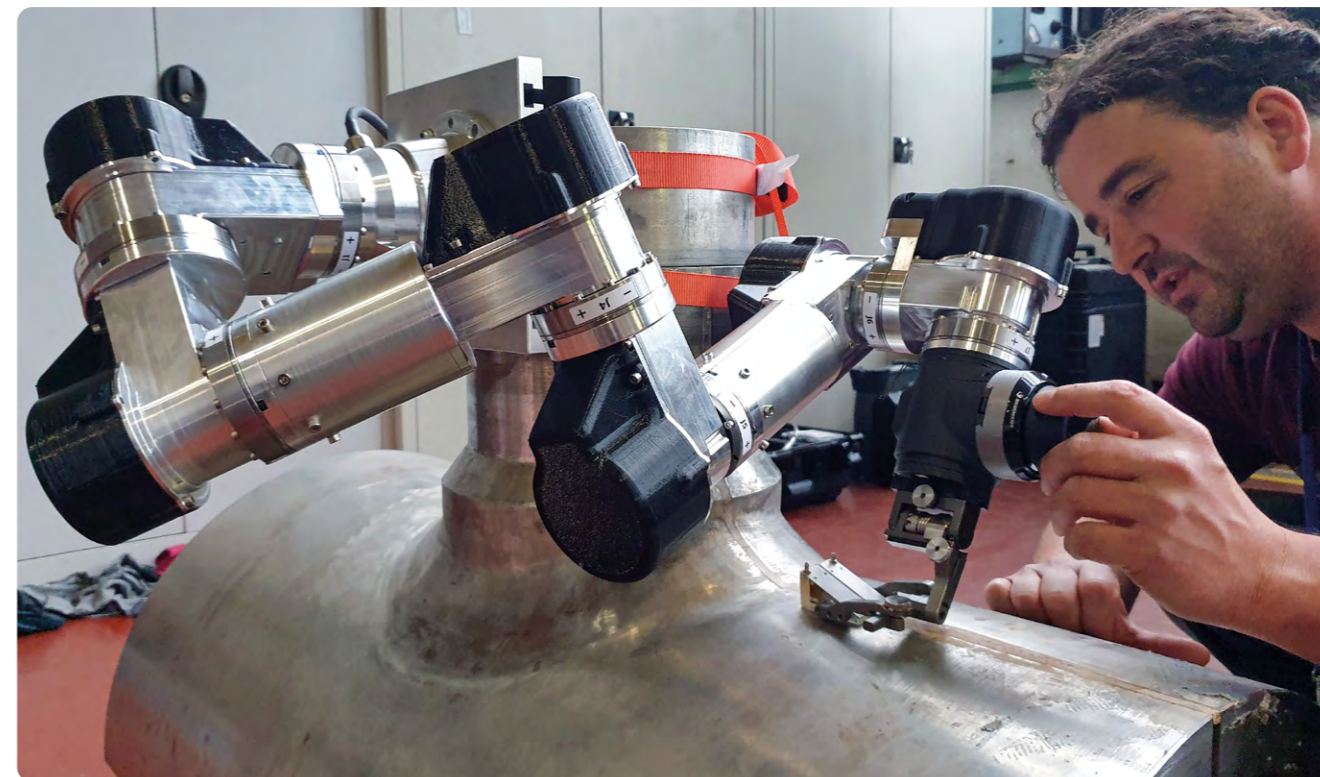
Obrázek: CHARM - intuitivní polohování sondy při NDT kontrole
