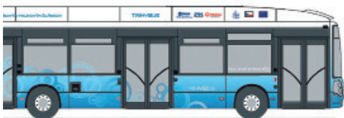
TriHyBus = Triple Hybrid (Hydrogen) Bus Palivový článek – trakční baterie – ultrakapacitory
