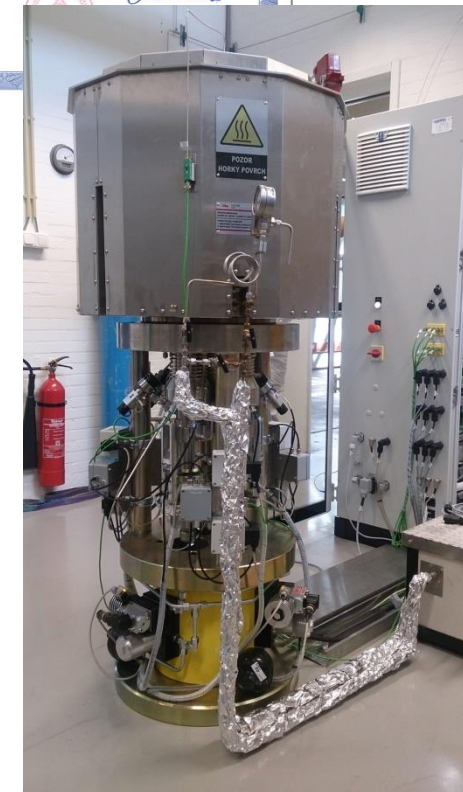
Autokláv pro zkoušky v prostředí (koroze únava), vyvinutý, zkonstruovaný a vyrobený ÚJV pro JRC Petten.
