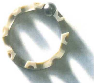
X6001TNBH P5R16-30S4 Lož.č.5 – plastová klec bez opotřebení, kulička- běžné opotřebení pláště po 161 hodinách chodu zkoušky ZDU.
